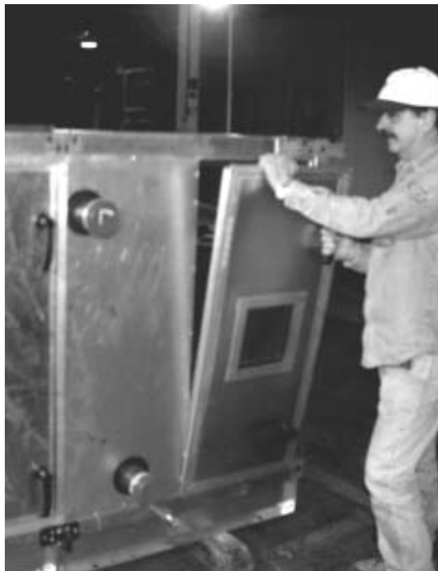
FIG. 3 - REMOVE DOOR ASSEMBLIES
